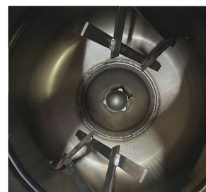
Sistema di mescolamento a doppia pala. Double blades mixing system.
